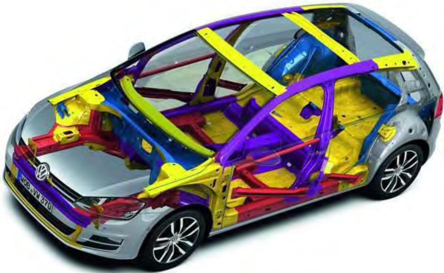
Рис. 7. Конструктивні рішення кузова для забезпечення пасивної безпеки сучасного автомобіля http://avtocentr.sumy.ua/kuzov-avtomobilya-aktyvna-i-pasyvna-bezpeka/
